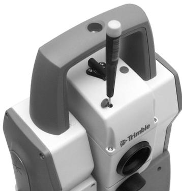
Para corregir la posición horizontal del punto láser, inserte la llave allen en el puerto de ajuste horizontal y gírela.
