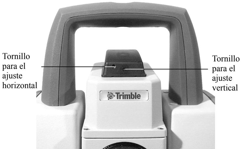
Figura 8.2 Tornillos para el ajuste del puntero láser
