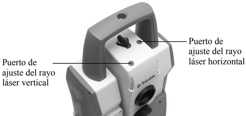
Para corregir la posición vertical del punto láser, inserte la llave allen en el puerto de ajuste vertical y gírela.
