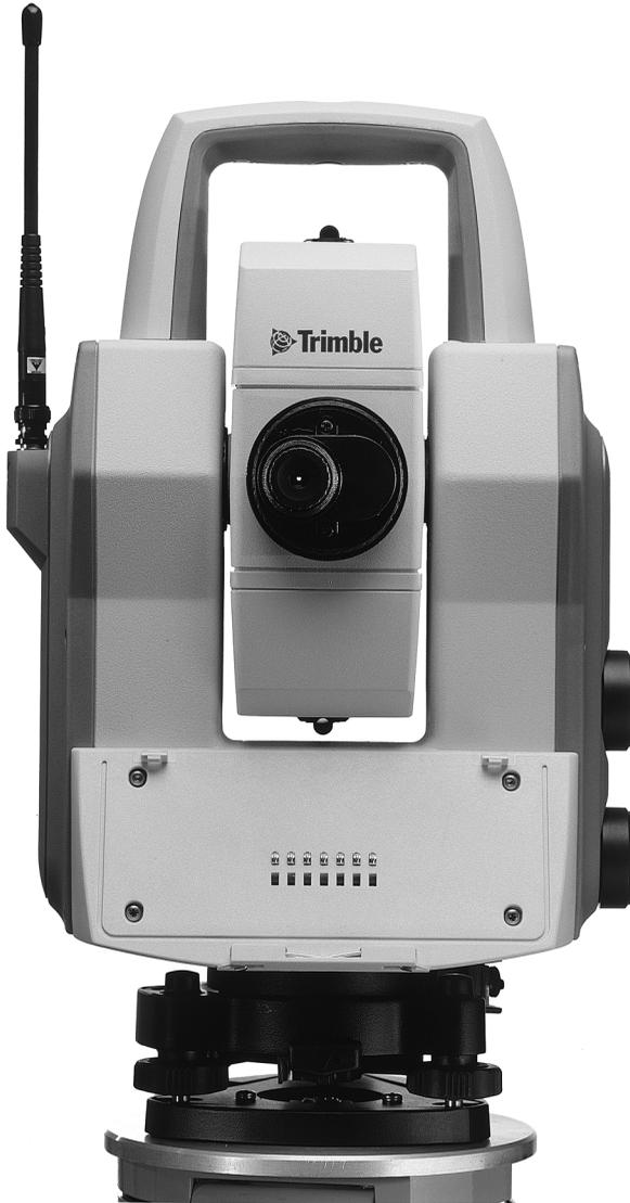
Figura 9.1 Tapa lateral con radio de la Serie Trimble 5600
