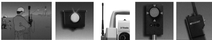
Con un seguidor y un enlace telemétrico, podrá efectuar la medición robótica. Esto significa que podrá hacerse cargo de toda la medición desde el punto, es decir, que dispondrá de un sistema unipersonal. En las páginas siguientes, se describen las distintas técnicas de medición con el sistema.
