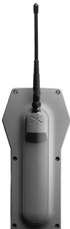
Este tipo de tapa se utiliza cuando se quiera utilizar el instrumento para la medición con mando a distancia o la medición robótica (estación total unipersonal). Véase el capítulo 1.5.
