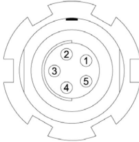
Figura B-3. Conector USB
