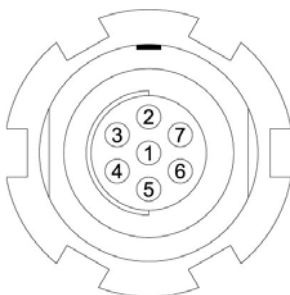
Figura B-2. Conector RS232
