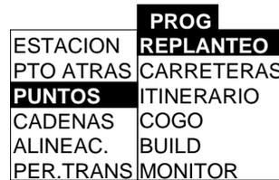
La opción "Utilización RC-1" del menú OPC.RC-1 debe ser "SI". Introduzca tanto el punto de la estación como el punto de referencia del lado del GTS-800A . Mida el punto de orientación del lado GTS-800A.
