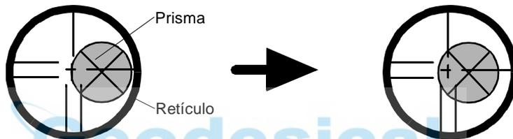
Confirme el nivel de la señal (nivel luminoso) en la pantalla y ajústelo en el nivel uno o dos como se indica a continuación, girando el transportador horizontal.
