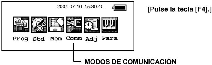
Los modos de comunicación se utilizan para ajustar la velocidad en baudios (protocolo), recepción de ficheros (recibir fichero) y transmisión de ficheros (enviar fichero). Su PC necesita un programa de comunicaciones compatible con (YMODEM) para transmisión y recepción de ficheros de datos.
