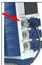
7. Instale el trípode para el transmisor de radio UHF, alejado unos metros del trípode del Z-Max.Net. La distancia entre los dos trípodes se halla limitada por la longitud (10 metros) del cable de datos/alimentación que conecta el receptor Z-Max.Net a la radio (véase el punto 10 más adelante).
