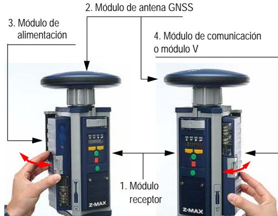
Mirando el panel frontal del módulo receptor GPS, el módulo de alimentación se fija al lado izquierdo del módulo receptor y el módulo de comunicación (o módulo V) al lado derecho.
