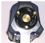
3. Introduzca el adaptador de latón de la base niveladora por el orificio de la placa de medición de HI, y atornille el adaptador y la placa al receptáculo roscado de 5/8" situado en la parte inferior del módulo receptor del Z-Max.Net.
