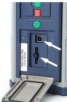
Bajo las cuatro teclas de control se encuentra una pequeña compuerta fijada por dos tornillos de aletas. Desatornillelos y abra la compuerta para exponer la ranura de la tarjeta SD y el puerto USB.
