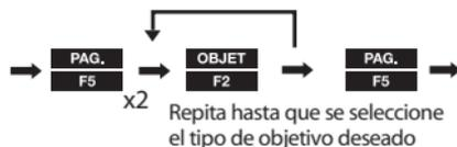
**NOTA:** Puede comprobar el tipo de objetivo seleccionado a la izquierda de la marca de Batería, en la línea superior de la pantalla.
