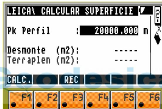
Introducir el Pk del perfil que se quiere calcular. Hay que tener en cuenta que en el fichero de perfiles se ha debido de grabar un perfil en el Pk a calcular y que la sección tipo esté definida en el pk solicitado.
