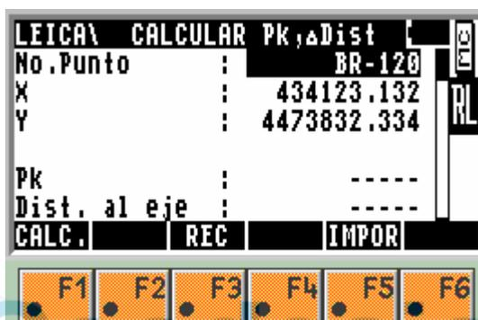
Introducir manualmente el N° de Punto y las coordenadas X e Y del punto a calcular. Una vez introducidos pulsar la teclas **CALC** para realizar el cálculo del Pk y Distancia al Eje del punto introducido. Si se desean guardar las coordenadas XY del punto calculado pulsar **REC**.
