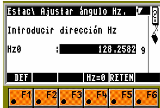
Existen dos métodos para orientar al azimut conocido:
