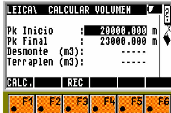
Introducir el intervalo entre los Pk's en los cuales se va a realizar el cálculo. El programa buscará todos aquellos perfiles que se encuentren dentro del intervalo marcado, calculará las superficies de todos aquellos en los cuales esté definida la sección tipo y se calculará el volumen de desmorte y terraplen.
