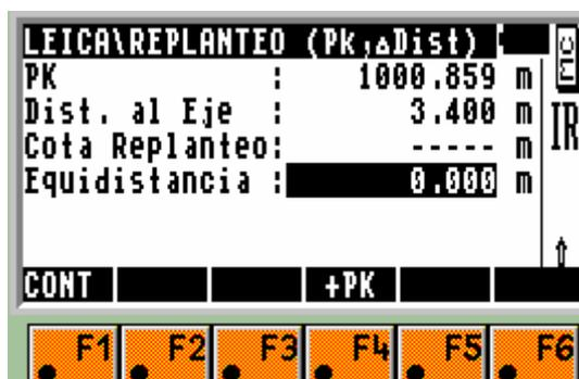
A continuación es necesario introducir el PK y la distancia al eje del punto a replantear. Si el punto está a la izquierda del eje habría que introducirla con un signo negativo. Si es necesario, se puede introducir la cota del punto a replantear: El valor de la variable **Equidistancia**, es una cantidad que se sumará o restará dependiendo del signo de su valor, al valor del Pk donde se esté replanteando, con sólo pulsar la tecla **F4**.
