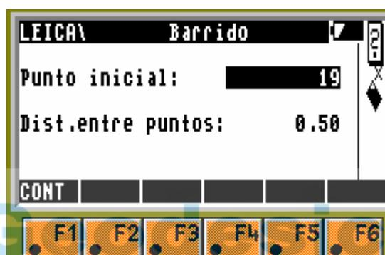
Para definir el plano en el espacio, es necesario medir tres puntos en una cierta secuencia. Es necesario medir los tres puntos en dirección contraria a la de las agujas del reloj, empezando con el punto bajo, izquierda (Punto 1 en el gráfico):
