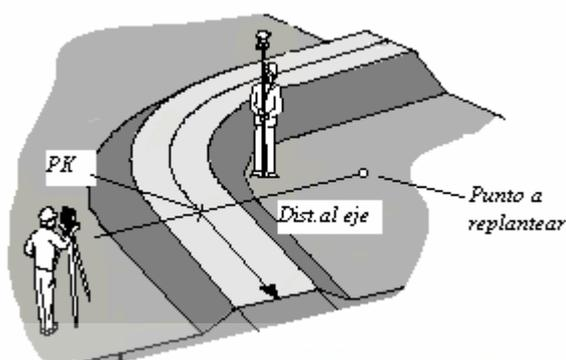
Esta opción permite el replanteo de un punto por su punto kilométrico y la distancia al eje, introduciendo el valor de la cota manualmente o bien obteniéndola del fichero de alzado. Desde este mismo programa también se podrá replantear los extremos de los segmentos de la sección tipo definida, ya sea Rasante, Subrasante, Cuneta o Talud y obtener la diferencia en cota entre el punto medido y el punto de la sección tipo.
