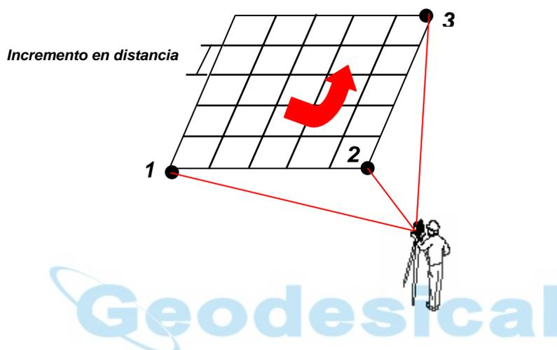
Una vez definido el plano de medición, es necesario introducir un incremento de distancia entre puntos. El programa calcula la proyección de los puntos teóricos sobre el plano definido y mide los puntos de manera automática.
