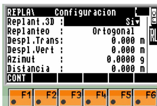
Replant. 3D : Replantear en 2D o 3D, seleccionando replanteo en 2D el ángulo vertical no variará.
