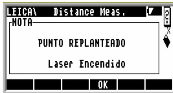
Si tras 5 iteraciones las desviaciones en coordenadas X/Y/Z son superiores a la tolerancia se nos mostrará el siguiente mensaje:
