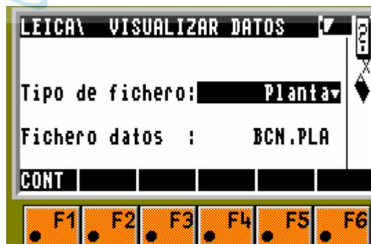
Pulsar la tecla Intro para ver los tipos de fichero disponibles (Planta, alzado y sección) y seleccionar el tipo de fichero a visualizar. A continuación, seleccionar el nombre del fichero y pulsar la tecla *CONT*.
