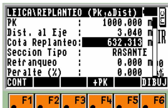
Primeramente se debe de seleccionar en el desplegable de **Sección Tipo** si se está trabajando en Rasante, Subrasante, Cuneta o Taludes, para realizarlo se debe de situar el cursor en la línea de Sección Tipo, pulsar la tecla enter y seleccionar una de las 4 opciones:
