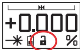
Para bloquear la posición de la pendiente, presionar y mantener presionada la tecla Estrella y después presionar una tecla de dirección Arriba o Abajo (a) para bloquear la pendiente en el valor actual.
