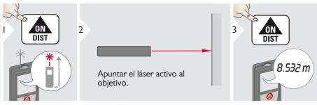
Superficies de objetivo: pueden producirse errores de medición al medir líquidos sin color, cristal, espuma de estireno o superficies semi permeables o al apuntar a superficies de brillo intenso. El tiempo de medición aumenta contra superficies oscuras.
