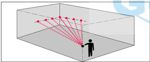
Determinar la distancia máxima, p.ej. para obtener la longitud de una diagonal.
