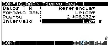
**Datos TR** - define el modo de operación del Receptor. Seleccione **Referencia** para transmitir datos en tiempo real.
