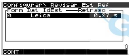
Al presionar la tecla **CONT (F1)**, se corta la conexión GSM y regresa a la pantalla anterior. El Id de la estación de referencia resaltada se copia en el campo **Id Est Ref**, siempre y cuando **Aceptar Ref** esté configurada con la opción **Def por Usua**.
