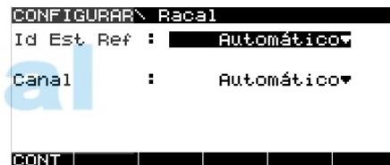
Las correcciones DGPS se pueden recibir de diferentes estaciones terrenas RACAL mediante diversos satélites. Cada satélite envía sus correcciones a través de diferentes pulsos (canales).
