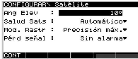
**Ang Elev** - Ángulo de elevación por debajo del cual, no se registrarán datos de los satélites ni se rastrearán o mostrarán estos. Para aplicaciones en Tiempo Real, el **Ángulo de elevación** se deberá configurar a 10°. Para aplicaciones únicamente de post-proceso, este parámetro se deberá configurar a 15°. Estos son los valores predeterminados para el **ángulo de elevación**, empleados por las configuraciones también predeterminadas del Sistema.
