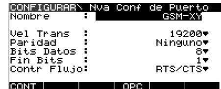
Los parámetros del puerto se emplean para establecer la comunicación entre el Sensor y el teléfono GSM. En caso necesario, edítelos según las características del teléfono.
