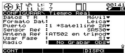
**Datos T R** - define el modo de operación del Receptor. Seleccione **Móvil** para la recepción de datos en tiempo real.
