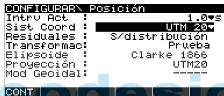
**Residuales** - Disponible al editar un sistema de coordenadas. Se despliega el método por medio del cual, se distribuirán los residuales sobre el área sujeta a transformación. Lo anterior ayuda a que la transformación resulte más realista y a eliminar deformaciones. **1/Dist**, **1/Dist<sup>2</sup>** y **1/Dist<sup>3/2</sup>** distribuyen los residuales de los puntos de control según la distancia entre cada uno de estos y el punto recién transformado.
