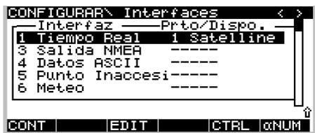
Seleccione el dispositivo en el cual desea cambiar de canal y oprima la tecla **CTRL** (F5).
