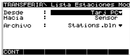
Seleccione **Desde** dónde desea transferir la lista de estaciones Modem/GSM. Automáticamente quedará seleccionado el dispositivo **Hacia** el cual será transferido.
