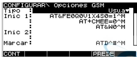
En el campo **Tipo** seleccione Usuario y modifique los parámetros que se despliegan. O bien, seleccione de la lista un tipo de teléfono GSM estándar y oprima la tecla **CFG->U (F5)** para cambiar a los parámetros de usuario y editarlos.
