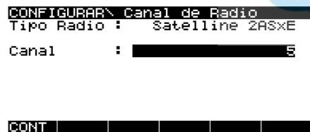
Para los radio módems Satelline 3AS, Pacific Crest RFM96W y Pacific Crest PDL, se revisa y despliega el canal con el cual está configurado el radio. Para otro tipo de radios resulta técnicamente imposible efectuar una revisión similar. Por lo tanto, el canal que se despliega no necesariamente coincide con el canal de radio actual.
