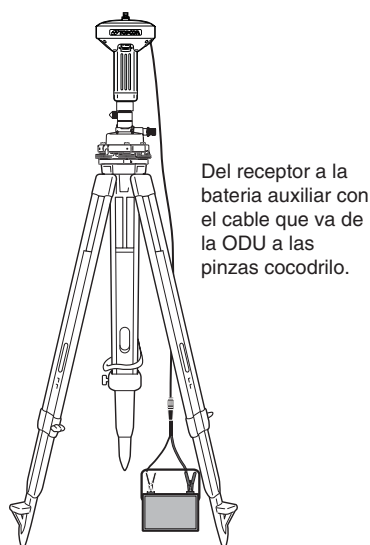
Figura 2-18. Conectar una Batería Auxiliar y el Receptor
