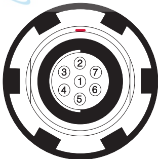
Figura A-2. Conector Serial RS232
