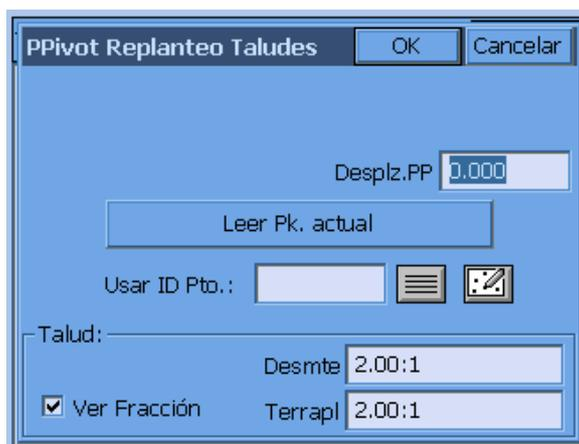
Para el replanteo de conducciones o cunetas en “V”, se introducirá un desplazamiento de pivote 0 desde la alineación definida por puntos. Si la cuneta tiene sección trapezoidal con una anchura de fondo de 2 metros, y la alineación es el eje, se puede replantear la pendiente de cada lado de la cuneta con un desplazamiento de pivote de 1 (la mitad de la anchura, desde el centro al punto pivote).
