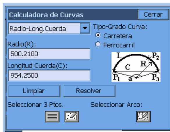
Se puede cambiar el tipo de curva entre carretera y ferrocarril. Los valores se pueden introducir en los campos en blanco mediante el teclado, seleccionando los puntos del trabajo actual en una lista de puntos o en la pantalla, o seleccionando un arco trazado en la pantalla. Cuando haya introducido los valores se mostrarán los resultados en la pantalla. Los resultados se pueden ver pulsando el botón “Resultados”. La curva se puede ver en la pantalla pulsando el botón “Ver curva”.
