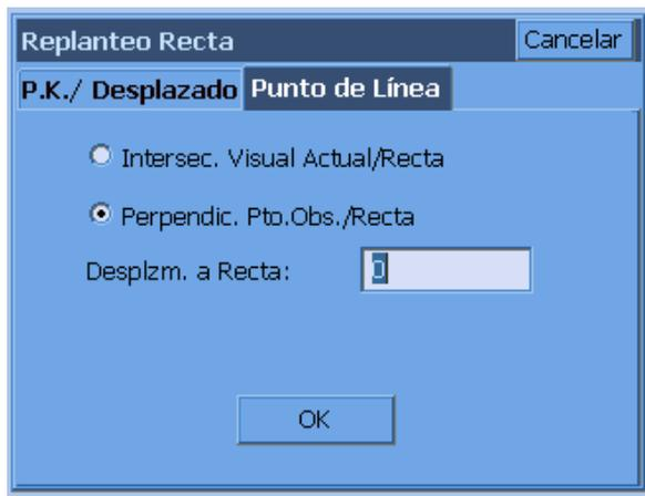
Estaciones totales, “Intersección con recta”: el método de intersección se utiliza para marcar líneas moviéndose hacia delante o hacia atrás en la línea visual actual. Una de las principales aplicaciones de este método es la marcación de líneas cuando éstas se encuentran bloqueadas por árboles u obstáculos, y se tiene que establecer la línea en intervalos en los que se tenga línea visual.
