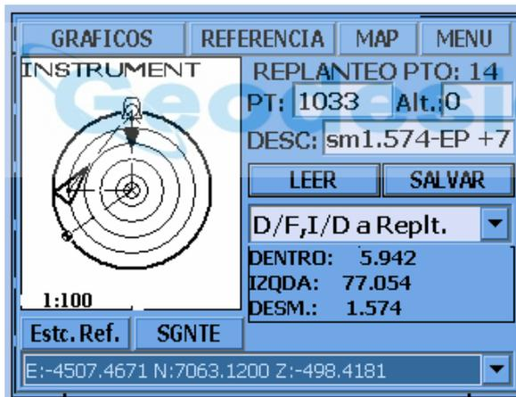
La siguiente imagen muestra una pantalla típica de estación total robotizada.
