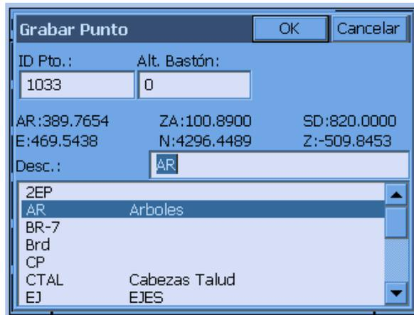
A menos que esté seleccionada la opción “Código/Altura del bastón”, la pantalla “Radiación/Poligonal” está diseñada para guardar los puntos rápidamente, debiendo el usuario introducir, antes de la hora, la descripción correcta y las alturas del bastón en los campos de la parte inferior del cuadro de diálogo.
