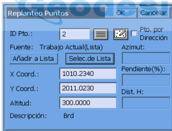
**Nota.** Pulsando la tecla de flecha hacia abajo en el replanteo en modo “Gráfico”, se puede aumentar el tamaño de la vista en planta eliminando parte de la información de texto. Al pulsar la tecla de flecha hacia arriba se mostrarán de nuevo el corte y el relleno.
