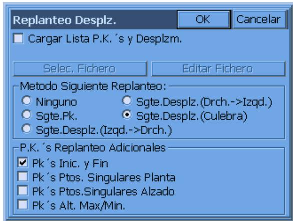
La opción “Cargar lista de PK y desplazamientos” permite a la rutina de “Replanteo de desplazados” usar una lista con datos de PK, desplazamientos y altitud predefinida por el usuario. Esto se denomina en ocasiones una lista de “informe de replanteo”. Se requiere un fichero ASCII con extensión “\*.cut”. A continuación se muestra el formato del fichero:
