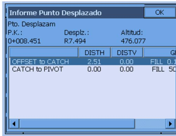
Finalmente, se le pedirá que replantee un segundo punto desplazado; es una opción que se usa con menos frecuencia para establecer una “línea” (dirección) desde la estaca del primer punto desplazado hasta la estaca de talud. Con ello se consigue volver a colocar la estaca de talud si se sale de su posición por efecto de los trabajos de construcción.
