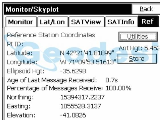
En el GPS Leica, que se muestra en el último cuadro de diálogo, se puede ver también el estado de la señal de radio en las dos líneas centrales. Si se interrumpe la señal de radio se mostrará el mensaje “Sin radio”. El botón de “Utilidades” asociado a la configuración del GPS Leica le llevará directamente a los parámetros de radio, donde se encuentran incluidos los parámetros de configuración del módem celular.
