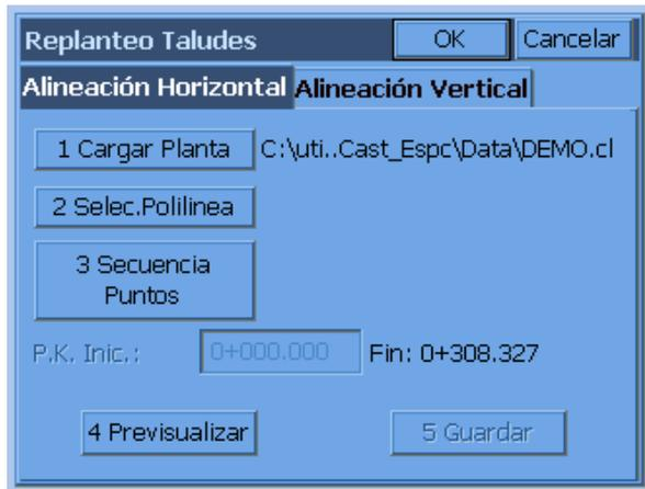
A pesar de que éste es el uso típico de la opción “Definida por puntos” (utilizando puntos), el replanteo de taludes se puede ejecutar a partir de un eje y una rasante simples o a partir de una polilínea tridimensional seleccionada. Los puntos se pueden seleccionar por su ID o se pueden marcar directamente en la pantalla.
