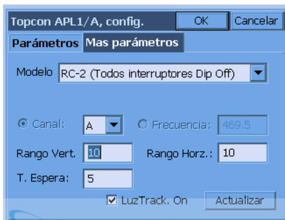
Es un instrumento de gran tamaño, que se utiliza con frecuencia en aplicaciones de construcción y control de maquinaria. La comunicación se realiza exclusivamente por radio, con radios de tipo 2ASx. Deberá introducir los parámetros de comunicación en APL1. Sólo tendrá que hacerlo una vez.
