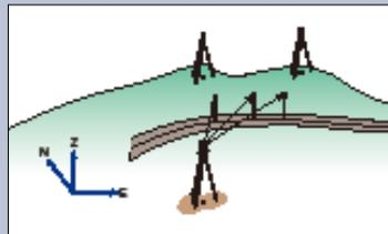
Replanteo tridimensional en coordenadas X,Y,Z o Y,X,Z.
