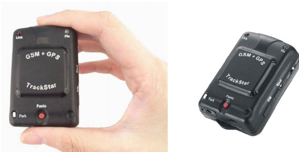
El TrackStarIII es un pequeño dispositivo de tan solo 100 gramos de peso (incluida la batería), que puede ser usado como rastreador personal y como dispositivo de seguridad.
