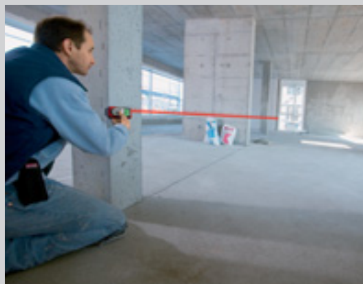
Medición de volúmenes: permite calcular el volumen de una habitación o la superficie de paredes y techos con sólo pulsar un botón
