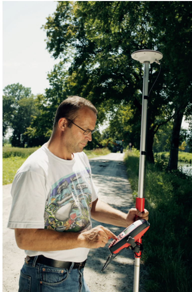
El SR20 tomando datos topográficos con precisión de centímetros mediante técnicas cinemáticas.
