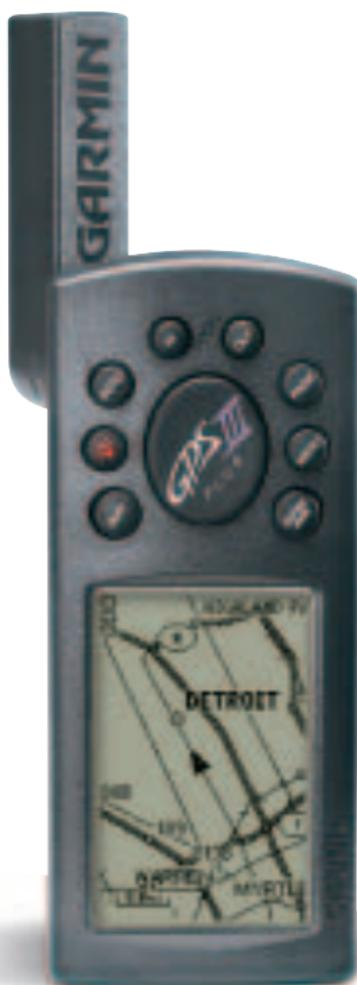
Por si no fuera poco, el GPS III PLUS añade una nueva dimensión a sus 36 horas de duración de las pilas y a su mapa base internacional incorporado: datos de mapa transferibles. El GPS III PLUS acepta 1,4 Mbytes de datos procedentes de los Cd's MapSource de Garmin y se suministra con un cable para PC así podrá transmitirlos directamente desde su ordenador. Puede elegir el CD MapSource de Carreteras y ocio o el WorldMap para obtener la información de las aventuras que vaya a experimentar.
