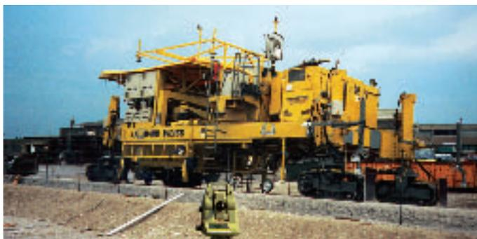
Supervisión de acabadores de firmes por encofrado, bituminadoras, niveladoras y dragas. Ventaja: Gracias a las medidas continuas en línea con el taquímetro, el operador se evita la costosa instalación de hilos conductores para el control de la maquinaria.
