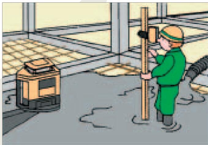
Una nueva ERA se abre para los niveles láser. ¡Topcon presenta un nuevo láser completamente autonivelante; sin tornillos de nivelación ni burbujas!
