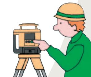
Encienda el receptor. Localice la posición "---", a nivel, moviendo el receptor arriba y abajo.
