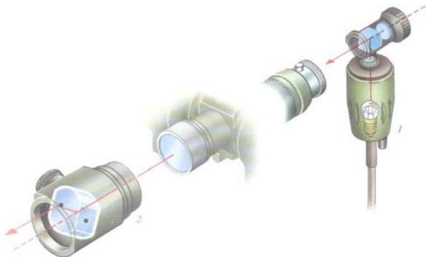
Algunos de los muchos accesorios para el ocular y el objetivo 1 Ocular de autocolimación 2 Micrómetro de placa planoparalela
